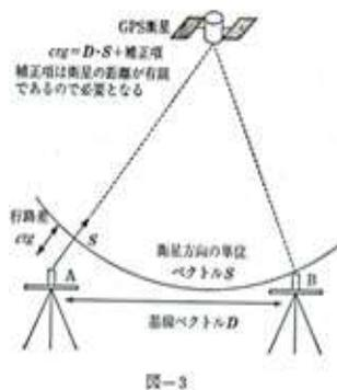
4. 電離層の中では、電波の速度が変わり、行路差の測定に影響する。この影響は、電波の周波数の2乗に比例する。
