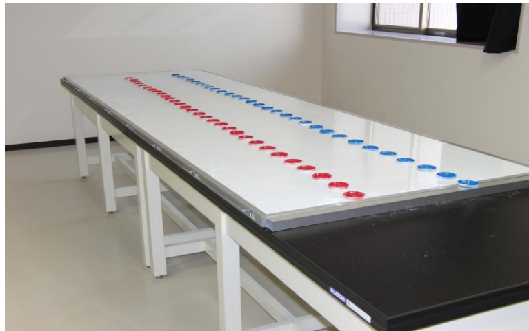
図2 波伝播ヒモを用いる波動実験装置
