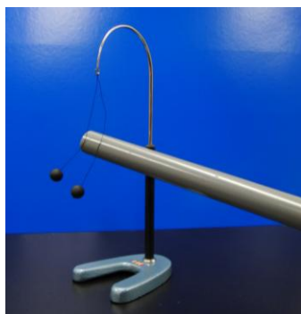
塩ビパイプの電気を電気ふりに移す
