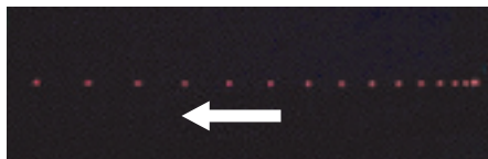
ストロボを使って摩擦のない斜面の運動を記録
