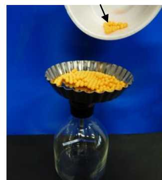
電気を持った BB 弾をのせていくとハクがだんだん開く
