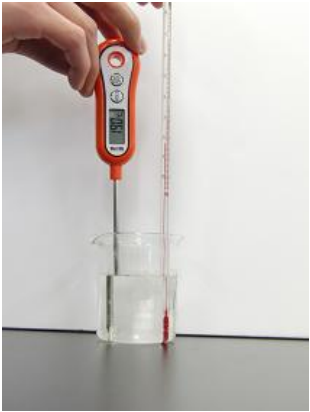
アルコール温度計とデジタル温度計で水の温度をはかっているところ
