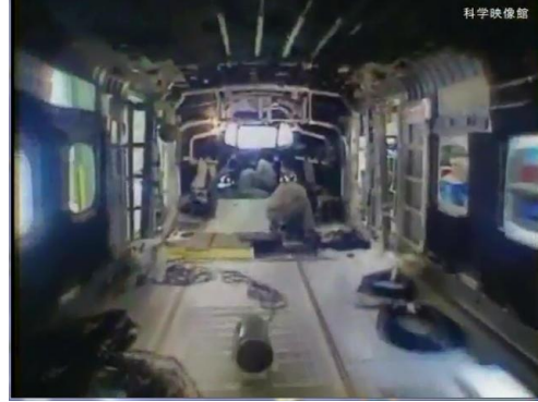
新幹線の車両を作っているところ
