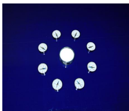
円形の磁場ができていることを小さな方位磁石(コンパス)で確認
