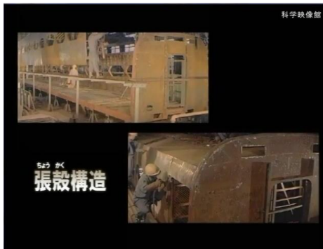
強度を上げるため、張殻構造とする
