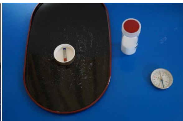
微小ビーズをまくと通常の棒磁石も 方位磁石（コンパス）として働く
