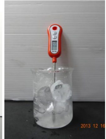
アルコール温度計とデジタル温度計で水と氷の温度をはかる
