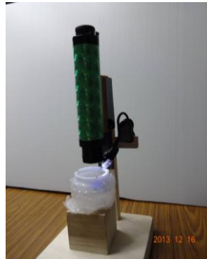
ルーペと接眼レンズを組み合わせた 手作り簡易顕微鏡 （ヨーグルトの容器に作る人工雪の 観察に用いる）
