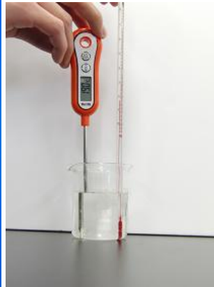
アルコール温度計とデジタル温度計で水と氷の温度をはかる
