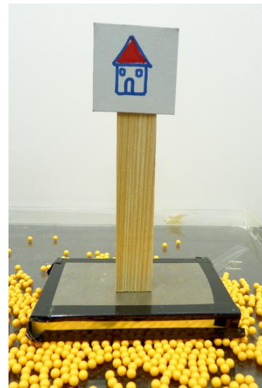
BB 弾を敷いた平面の上に家の模型を置いて、BB 弾の入った容器を左右に激しく動かします
