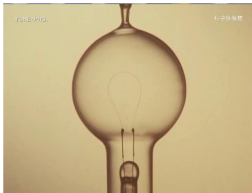
1879年、エジソンが発明したカーボンフィラメントの電球（日本の竹が使われた）
