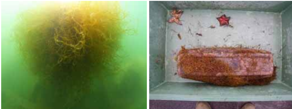
図 6-12 5月調査時のリサイクルブロック(D.L.-3m)の様子
