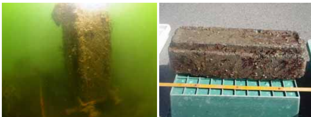
図 6-13 7 月調査時のリサイクルブロック(D.L.-3m)の様子
