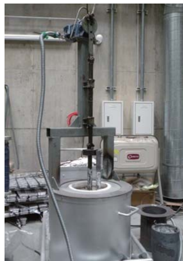
アルミ溶湯(ADC-12)に対する 浸漬試験機
